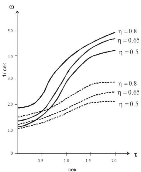
**Рис. 3.** Дисперсионные кривые для продольных волн в области со скважинами при различных реологических характеристиках грунта (сплошные линии для упругой модели грунта, пунктирные линии для вязкоупругой модели грунта).
