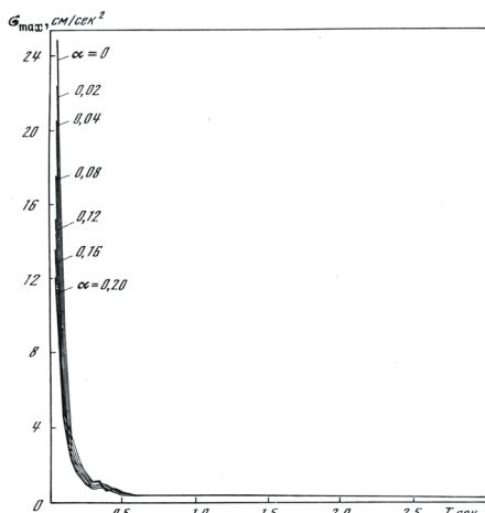
**Рис.1.** Изменение сжимающих (нормальных) напряжений в грутовом массиве с учетом реологии грунта
