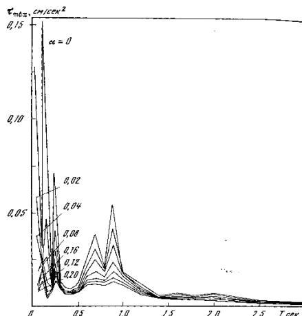
**Рис. 2.** Изменение растягивающих (разрушающих) напряжений в зависимости от учета реологии грунта
