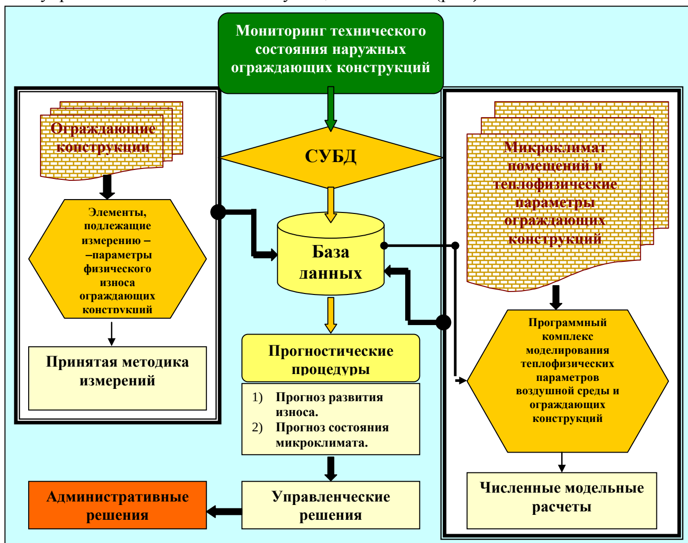
Рис. Составляющие мониторинга технического состояния наружных ограждающих конструкций
