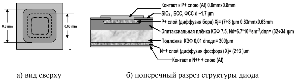
Рис. 3. Геометрический разрез планарного высокочастотного диода
