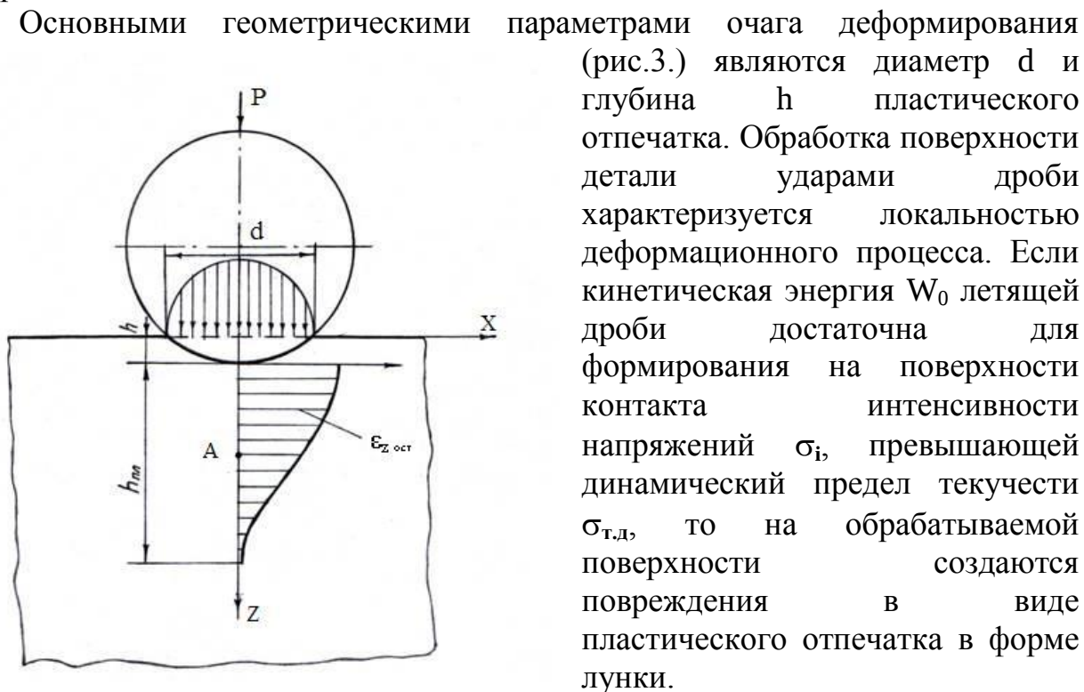
Рис. 3. Схема динамического вдавливания шара в упрочняемую поверхность и качественная эпюра остаточных деформаций осевого сжатия по толщине пластически деформированного слоя h_{пл}
