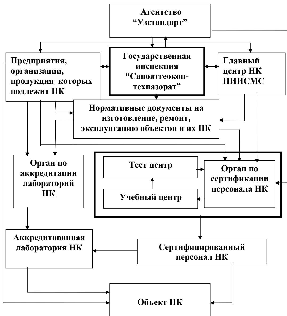
Рис.2. Структура национальной системы неразрушающего контроля
