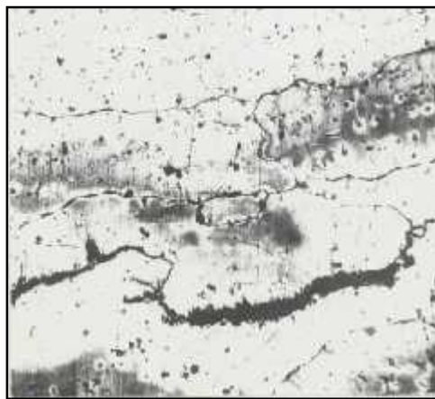
Рис. 4. Микротрещины по границам зерен наплавленного металла (ОМГ-Н)
