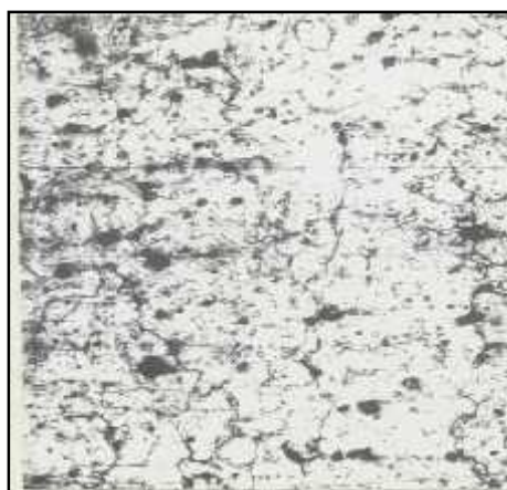
Рис.6. Микроструктура (аустенитная) наплавленного ЦНИИН-4 на 110Г13Л
