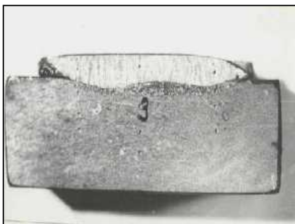
Рис. 5. Макроструктура сплава ЦНИИН-4, наплавленного на сталь 110Г13Л
