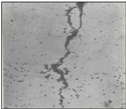
Рис.3. Микротрещины в переходной зоне (ОМГ-Н). Шлиф не травлен
