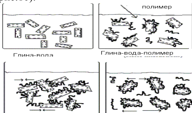
Рис.10 Схематическое представление синтетических полимеров и частицы бентонита
