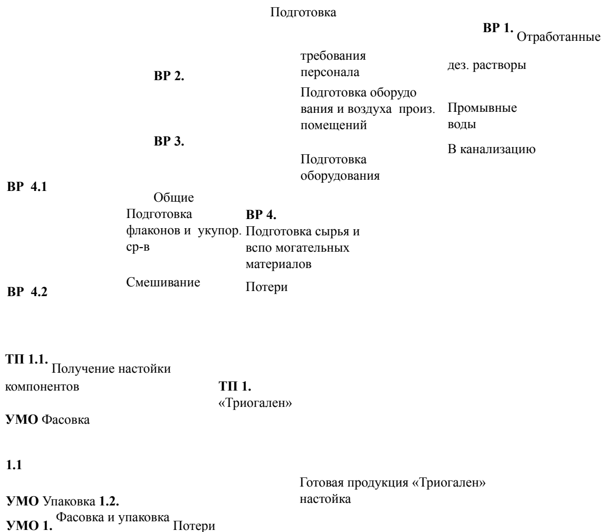
Рис. 4. Технологическая схема производства препарата «Триогален»
