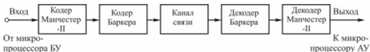
Рис. 5. Структурная схема кодирования сигналов управления разъединителями
