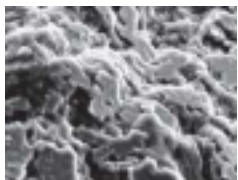
10-расм. Бактерия билан ишлов берилгандан сўнг ювишдан олдин ҳудудларнинг ташқи кўриниши. Аншлифнинг ташқи юзасида ярозит билан бирга бактерия
