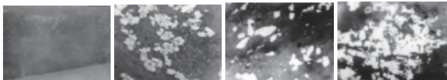
1 2 3 4 14-расм. Маъдан намуналарининг аншлифи(колоннанинг пастки қисми) 1,2-бактериялар билан ишлов беришдан аввалги аншлиф; 3,4- бактериялар билан ишлов бергандан сўнг;
