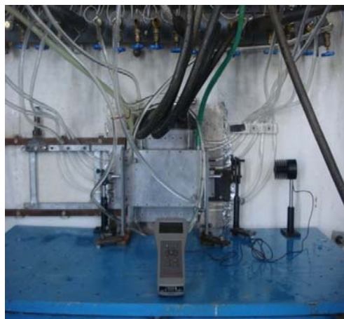
Рис. 1. Лазерный модуль на фокусе БСП в собранном виде.
