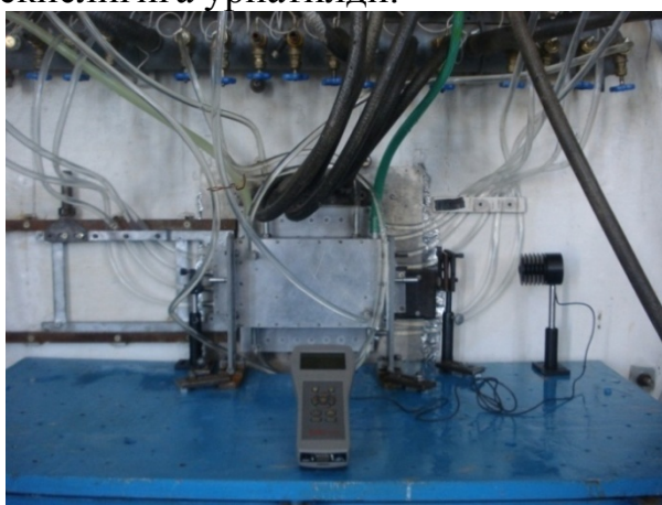
1-расм. КҚП фокусига жойлаштирилган лазер модулининг йиғилган кўриниши.
