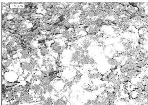
3.1 – расм. ППМ-1 саноат маҳсулотининг микроструктураси, х300
