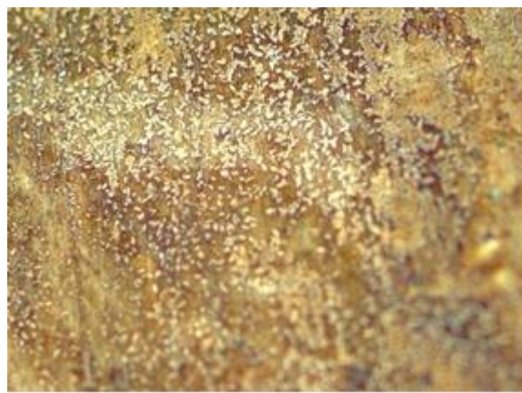
3-расм. 0,5 мм гача прокатланган ва юмшатирилган мис полосасининг микроструктураси (x100)
