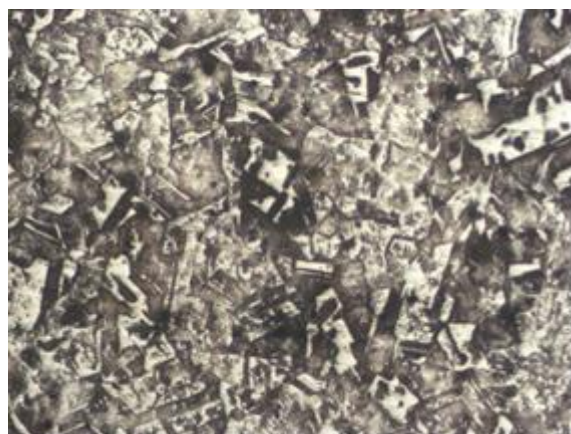
Рис. 2. Микроструктура прокатанной до 3,0 мм и отожженной полосы (x100)
