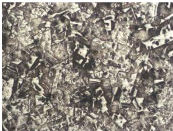
2-расм. 3,0 мм гача прокатланган ва юмшатирилган мис полосасининг микроструктураси (x100)
