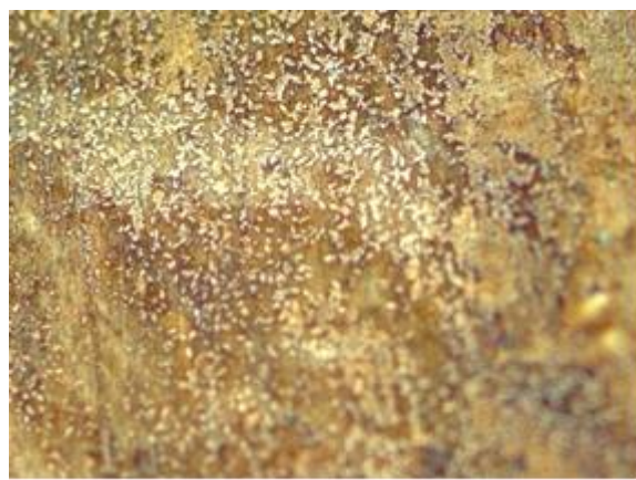
Рис. 3. Микроструктура прокатанной до 0,5 мм и отожженной полосы (x100)
