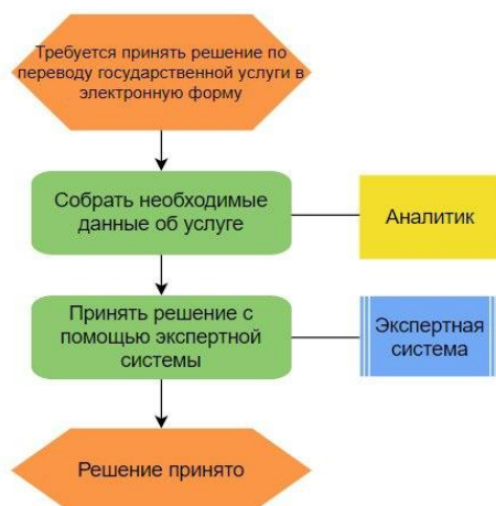
Рис. 4. eEPC диаграмма процесса принятия решения по переводу государственной услуги в электронную форму с использованием экспертной системы
