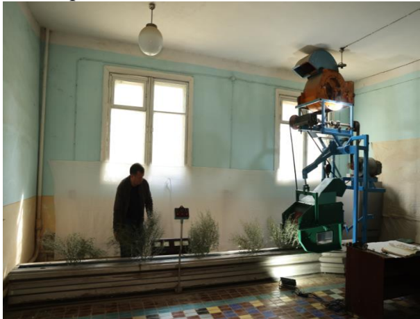
Рисунок 3. Лабораторный стенд для исследования различной формы ножей роторного режущего барабана
