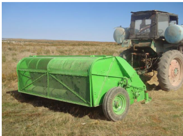
Рисунок 1. Косилка-копнитель КПП-3,0 для скашивания пустынных кормовых растений
